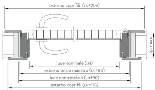
Sezione telaio orizzontale
