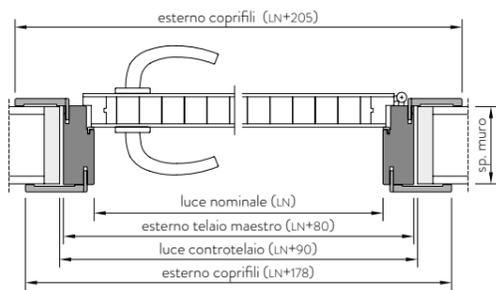
Sezione telaio orizzontale
